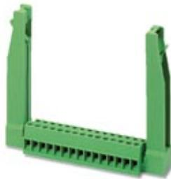
Блок для непосредственного монтажа, номинальный ток: 12 A, расчетное напряжение (III/2): 320 В, полюсов: 22, размер шага: 5,08 мм, тип подключения: Винтовой зажим с натяжной гильзой, цвет: зеленый, поверхность контакта: олово, монтаж: Непосредственный монтаж
