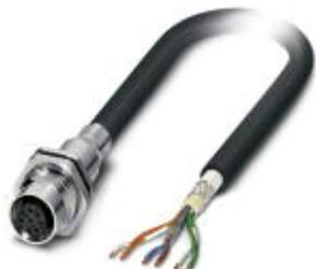
Встраиваемая розетка шинной системы, VARAN, 6-полюсная, M12, экранированная, монтаж с задней части стенки / резьбовое крепление с M16, с кабелем шины длиной 0,5 м
