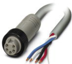
Системный кабель шины, DeviceNet™, 5-полюсн., ПВХ, серый, свободный конец, к Гнездо прямое 7/8"-16UNF, длина кабеля: 2 м
