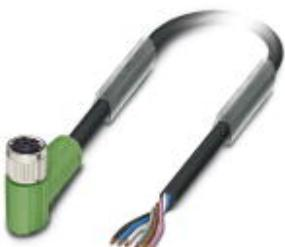
Кабель для датчика / исполнительного элемента, 6-полюсн., PUR без галогенов, темно-серый RAL 7021, свободный конец, к Гнездо угловой M8, длина кабеля: 1,5 м
