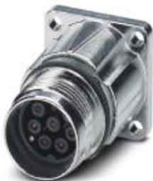
Аппаратн. соединитель, передняя стенка, прямой, для стандартной блокировки и SPEEDCON, M17, полюсов: 7+PE, тип контактов: Розетка, Обжим, Аксиальное уплотнительное кольцо, 4x Ø2,7, экранирован.: есть, размер фланца: 21,6 мм x 21,6 мм
