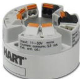
Измерительный преобразователь с питанием от выходного контура передает до двух сигналов датчиков RTD и TC, а также датчиков сопротивления и напряжения по протоколу связи HART или 4 ... 20 mA, в зависимости от конфигурации. SIL2/3
