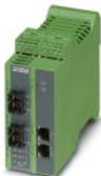
T-образные устройства сопряжения для сетей Ethernet, для сопряжения 2x RJ45 и 2x SC-RJ LWL, 660 нм, расстояние 100 м при использовании волокна HCS, для всех типов сетевых структур, резервирование с помощью RSTP + FRD, конфигурирование с помощью WBM, IGMP-Snooping, многоадресная фильтрация, VLAN, SNMP и зеркалирование портов.
