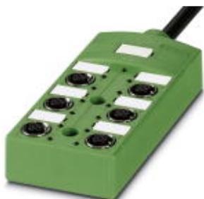
Коробка датчика и исполнительного элемента, применение: Стандартн., тип подключения: Гнездовой разъем M12-SPEEDCON металл, количество гнезд: 6, полюсов: 5, механические ключи: А - стандарт, гнездо для платы: Двойной, индикатор состояния: Нет, Универсальный; подключение магистрального кабеля: Жесткое подключение 180°, PUR, не содержащий галогена, длина кабеля: 5 м, экранировка: нет
