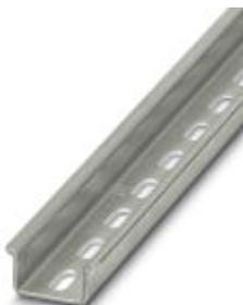
DIN-рейка, с перфорацией, Стандартный профиль, ширина: 35 мм, высота: 15 мм, соотв. EN 60715, материал: Сталь, оцинковка, белая пассивация, длина: 2000 мм, Размер отверстия: 5,2 x 25 мм, цвет: серебристый
