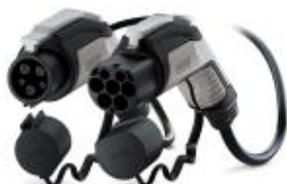
Мобильный зарядный кабель переменного тока с автомобильным и инфраструктурным зарядными штекерами, с возможностью установки навесного замка и защитным колпачком, C-Line черный / серый, Тип 1, GB/T, GB/T 20234.2-2015, SAE J1772, 16 A / 250 В (AC), тип конструкции C-Line, кабель: 5 м, черный, прямой, поверхность сопряжения: черный, область захвата: серый
