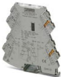
Универсально настраиваемый разделительный усилитель 4 цепей, с выходным переключающим контактом и штекерными разъемами с гальванической развязкой аналоговых сигналов. Настраивается DIP-переключателями или с помощью ПО. Зажимы push-in, заказная конфигурация.
