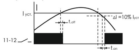
При превышении установленного значения тока  $I_{уст}$  реле переключается через время задержки выключения  $t_{off}$  (контакты 11-12 размыкаются, контакты 10-11 замыкаются). При снижении величины тока (с учетом гистерезиса  $\Delta I$ ) реле возвращается в исходное состояние через время включения  $t_{on}$  (контакты 11-12 замыкаются, 10-11 размыкаются).
