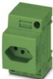
Розетка, Схема расположения контактов тип N, Винтовые зажимы, для Бразилии / Южной Африки и других стран, зеленый, для монтажа на несущую рейку и в интерфейсе обслуживания или прямого монтажа, 250 В AC, 20 А, -20 °С, 60 °С, NBR 14136
