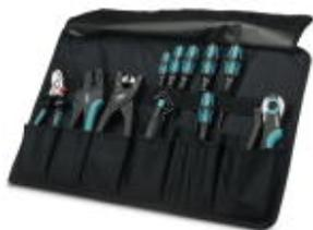
Сворачивающаяся сумка для инструмента, в комплекте: кабельный резак, инструмент для снятия изоляции со стандартных проводников 0,08 мм<sup>2</sup> ... 16 мм<sup>2</sup>, инструмент для снятия оболочки до Ø 40 мм, клещи для наконечников CRIMFOX CENTRUS 6H для проводников 0,14 мм<sup>2</sup> ... 6 мм<sup>2</sup>, отвертка VDE, узкая, шлиц: 0,6x3,5 / 0,8x4,0 / 1,0x5,5, крест: PH1/PH2/PZ1/PZ2
