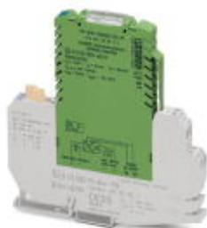
Взрывобезопасный (Ex i) двоичный вход: Коммутирующий разделительный усилитель NAMUR. Для бесконтактных датчиков и переключателей, эксплуатирующихся во взрывоопасных зонах. Сигналы передаются в безопасную зону. Транзисторный выход (пассивный), функция обнаружения ошибок в линии. Устройство для гальванической развязки 3 цепей.
