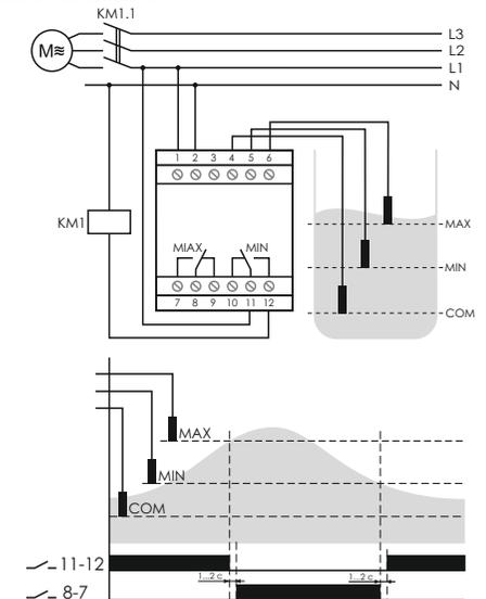
При подаче питания через 2 секунды реле входит в рабочий режим, замыкаются контакты 11-12 (контакты 8-7 разомкнуты). Если уровень жидкости ниже зонда MIN, контакты реле 11-12 замкнуты, насос включается и происходит наполнение резервуара.
