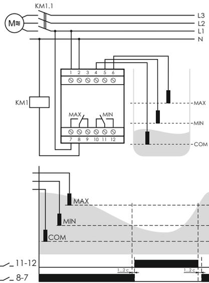
При подаче питания через 2 секунды реле входит в рабочий режим, контакты 8-7 остаются разомкнуты (11-12 замыкаются). Если уровень жидкости выше зонда MAX, контакты реле 8-7 замыкаются (11-12 разомкнуты), насос включается и происходит откачка жидкости из резервуара. При достижении жидкостью уровня MIN контакты 8-7 размыкаются (11-12 замыкаются), насос выключается. При повышении уровня жидкости до уровня зонда MAX контакты 8-7 замкнутся (11-12 разомкнуться), включится насос.
