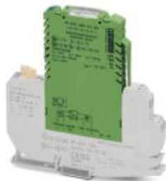
Модуль управления клапаном Ex i, вставной. Для управления искробезопасными электромагнитными клапанами, устройствами аварийной сигнализации и другими простыми электрическими устройствами установленными во взрывоопасной зоне. Для газов группы IIC, общее питание. Гальваническая развязка.
