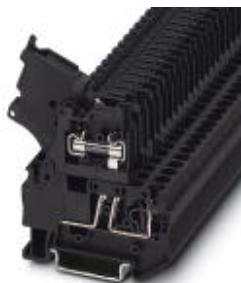
Клеммный модуль предохранителя, для монтажа на NS 35, для патронных плавких вставок 5 x 20
