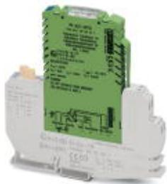
Измерительный температурный преобразователь Ex i: преобразует результаты измерений термометра сопротивления во взрывоопасной зоне в сигнал 0/4 мА ... 20 мА для неискробезопасной нагрузки. Свободно программируется. Гальваническая развязка 3 цепей.
