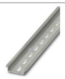
DIN-рейка, с перфорацией, Стандартный профиль, ширина: 35 мм, высота: 7,5 мм, согласно EN 60715, татериал: Сталь, оцинкован., пассивирован., длина: 2000 мм, цвет: серебристый
