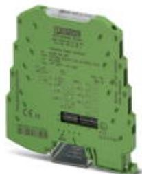
Конфигурируемый частотный измерительный преобразователь предназначен для подключения бесконтактных датчиков NAMUR и датчиков с выходами типа NPN и PNP. Конфигурирование производится DIP-переключателем и Teach In Wheel. Винтовой разъем, стандартная конфигурация.
