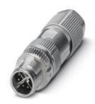
Шинный системный соединитель, Ethernet CAT6<sub>A</sub> (10 Гбит/с), 8-полюсн., экранирован., Штекеры прямое M12 SPEEDCON, X-кодирование, Piercecon®, материал накатанной гайки: Цинк. литья под давлением, с никелевым покрытием, наружный диаметр кабеля 4 мм ... 8 мм
