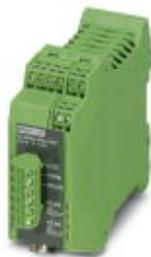
Промышленный расширитель SHDSL для последовательных интерфейсов RS-232/422/485, точка-точка и линейные структуры, последовательная передача данных со скоростью до 2000 кбит/с по кабелям предприятия, диагностика посредством USB и СИД, два настраиваемых выхода аварийной сигнализации
