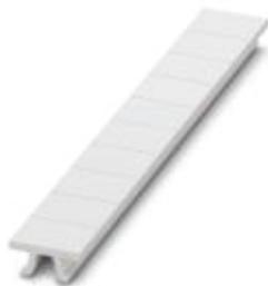
Планка Zack, Полоса, белый, без маркировки, маркируется с помощью: CMS-P1-PLOTTER, PLOTMARK, тип монтажа: крепление в высоких пазах для табличек, для клемм шириной: 8,2 мм, размер маркировочного поля: 10,5 x 8,15 мм
