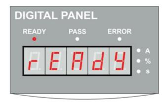
Рис. 10: Устройство готово к работе
