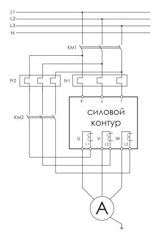
б) Два устройства защиты от перегрузки
