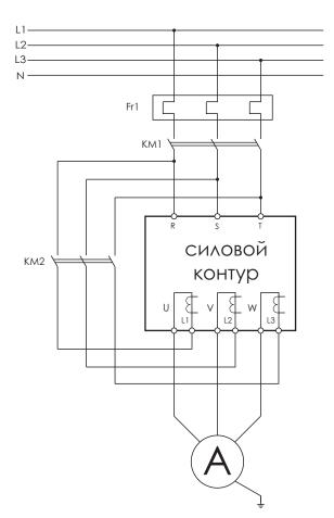
а) Одно устройство защиты от перегрузки Рис. 5: Подключение силовой цепи
