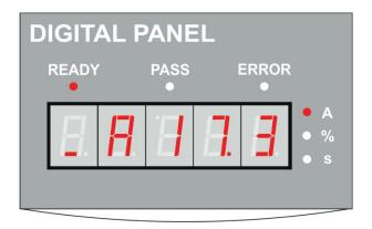
Рис. 15: Остановка Контактор байпаса отключается и торможение осуществляется с помощью устройства. На дисплее отображается текущее значение тока.
