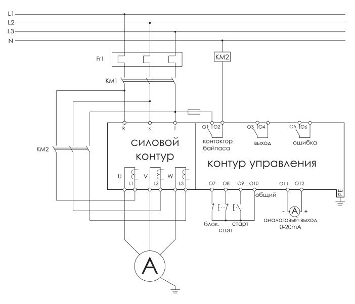
Рис. 4: Схема подключения
