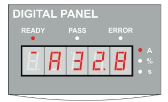
Рис. 13: Запуск. Двигатель питается через устройство. На дисплее отображается текущее значение тока.
