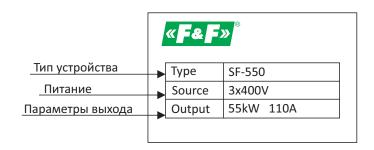
Рис. 1: Заводская табличка устройства
