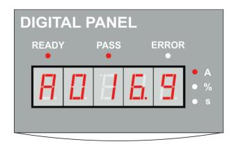
Рис. 14: Работа Двигатель получает питание через контактор байпаса (горит индикатор PASS). На дисплее отображается текущее значение тока двигателя.
