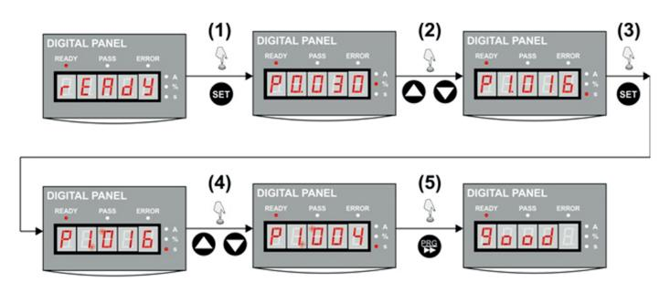
Рис. 18: Схема редактирования параметров
