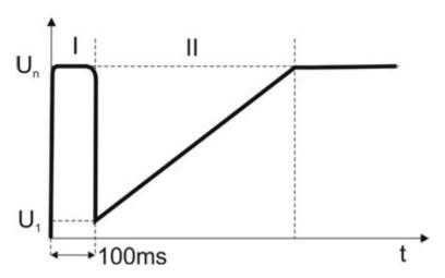
Рис. 22: Резкий пуск и линейный рост напряжения
