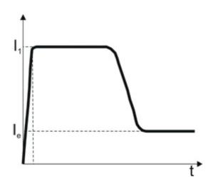
Рис. 19: Пуск с ограничением максимального тока
