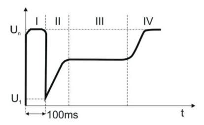
Рис. 21: Резкий пуск и ограничение тока
