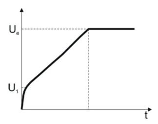
Рис. 20: Пуск с линейным нарастанием напряжения
