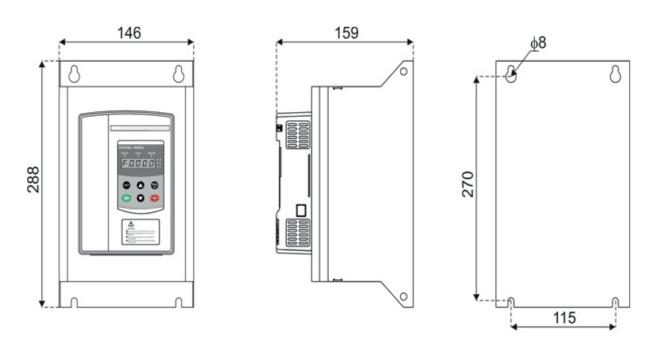
Рис. 3: Размеры устройства и монтажные отверстия
