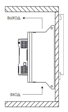
Рис. 2: Пример правильной установки устройства
