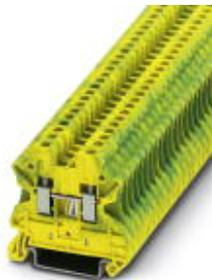
Клемма защитного провода, тип подключения: Винтовые зажимы, количество точек подсоединения: 2, сечение: 0,14 мм<sup>2</sup> - 4 мм<sup>2</sup>, AWG: 26 - 12, ширина: 5,2 мм, высота: 46,9 мм, цвет: желто-зел., тип монтажа: NS 35/7,5, NS 35/15
