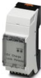
Устройство снятия блокировки EV Charge обеспечивает контроль рабочего напряжения (12 В) электродвигательного исполнительного элемента штекерного фиксатора, передает сигналы о блокировке и разблокировке и подает исполнительному элементу импульс к снятию блокировки в случае критического падения рабочего напряжения.
