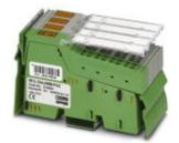
Inline, Ведущее устройство DALI, Поддержка нескольких ведущих устройств, встроенный блок питания DALI, безопасная гальваническая развязка, скорость передачи данных в локальной шине: 500 кбит/с, степень защиты: IP20, включая штекеры Inline и поля для маркировки
