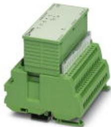
Аналоговый модуль ввода INTERBUS-ST, 8 входов, 0-5 В, 0-10 В, 0-25 В, 0-50 В, 0-20 мА, 4-20 мА, 0-40 мА, 0-60 мА, класс защиты IP20, включающий в себя: зажимной блок с винтовым разъемом и электроникой модуля
