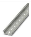
DIN-рейка, с перфорацией, Стандартный профиль, ширина: 35 мм, высота: 7,5 мм, согласно EN 60715, татериал: Сталь, оцинкован., пассивирован., длина: 500 мм, цвет: серебристый
