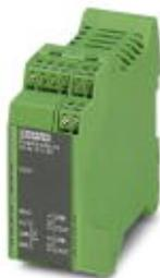
Первое поколение: неуправляемый расширитель Ethernet, для соединений точка-точка, линейные и кольцевые структуры, скорость передачи данных до 30 Мбит/с, удаленность до 20 км по заводским медным кабелям, диагностика при помощи USB и светодиодов, 2 порта SHDSL, 1 порт LAN
