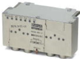
Повторитель для контроля и усиления сигнала для INTERBUS; оптоволоконно, скорость передачи данных 2 Мбод, делит систему на сегменты и позволяет отключать отдельные ветви во время эксплуатации
