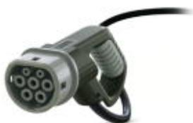
Зарядный кабель перем. тока с автомобильным зарядным штекером, без разъема, с защитным колпачком, Designline 1, Тип 2, МЭК 62196-2, 32 A / 250 В (AC), тип конструкции D-Line, кабель: 10 м, черный, прямой, ВНИМАНИЕ: передача сигналов зависит от длины кабеля, и поэтому возможно снижение качества., поверхность сопряжения: серый, область захвата: серый
