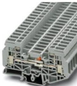
Измерительная клемма с ползунковым размыкателем, тип подключения: Винтовые зажимы, сечение: 0,5 мм<sup>2</sup> - 10 мм<sup>2</sup>, AWG: 20 - 10, ширина: 8,2 мм, тип монтажа: NS 35/7,5, NS 35/15, NS 32, цвет: серый
