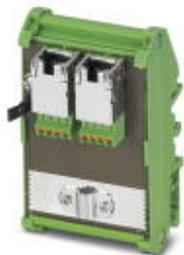
Модуль разделения кабеля, два гнезда RJ45 с расположением контактов Ethernet (отвод кабеля вверх), на 8 клемм с пружинным усилием, CAT5e, 10/100 Мбит/с, установка на монтажную рейку, IP20, экран соединяется с монтажной рейкой посредством перемычки (на выбор)
