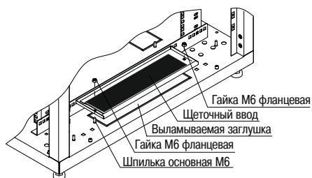
Рисунок 16 – Монтаж щеточного ввода
