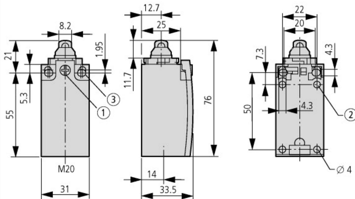
① Вращающий момент затяжки винта крышки:  $0,8 \text{ Nm} \pm 0,2 \text{ Nm}$
