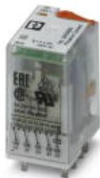
Вставное промышл. реле с силовыми конт., 4 перекл. контакта, тестовая кнопка, светодиодный индикатор сост., мех. индикатор коммутац. полож., входное напр.: 230 В AC
