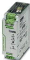
Преобразователь пост. тока QUINT с регулированием в первичной цепи и широким диапазоном входных напряжений для установки на несущей рейке с технологией SFB (Selective Fuse Breaking), вход: 60-72 В пост. тока, выход: 24 В пост. тока / 10 А
