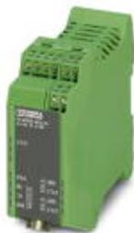
Промышленный расширитель для PROFIBUS, для соединений точка-точка, линейных структур и сетей со смешанной топологией с повторителем и преобразователем для оптоволокну. Расстояния до 20 км, скорость передачи данных PROFIBUS до 1,5 Мбит/с по простым медным проводникам телефонной линии.
