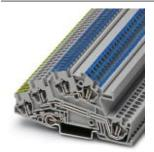
Заземляющие клеммы для выполнения проводки в зданиях, Пружинный зажим, сечение: 0,08 мм² - 4 мм², AWG: 28 - 12, ширина: 5,2 мм, цвет: серый, тип монтажа: NS 35/7,5, NS 35/15
